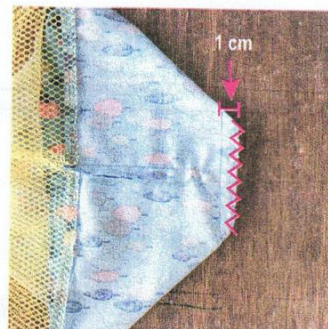
n) Piquer. Couper l'angle à 1 cm. Surfiler ou point zig-zag.
