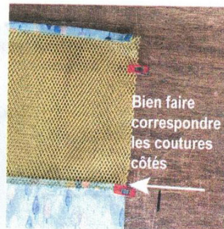
k) Assembler les côtés. Tissu endroit contre endroit.
